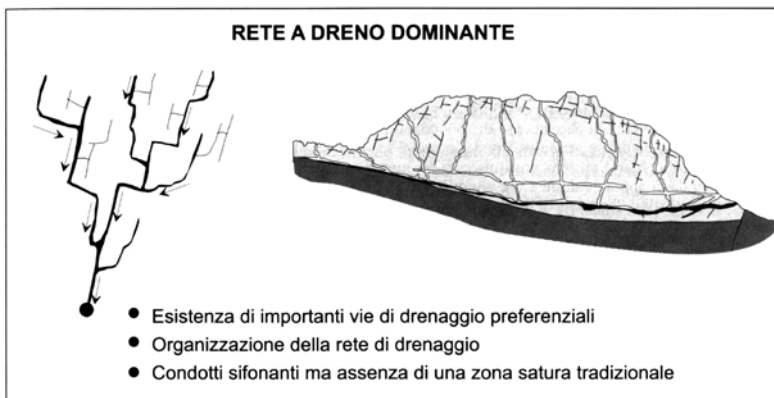
Figura 14 - Rappresentazione schematica di un sistema di drenaggio del tipo “rete a dreno dominante” (da Vigna B. e Calandri G., 2001).
